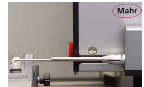
Profiltasten gegen CAD-Daten
